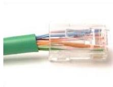
A figura seguinte mostra um cabo UTP devidamente terminado. É um bom conector com fios que não são torcidos apenas na extensão necessária para conectar o conector.
